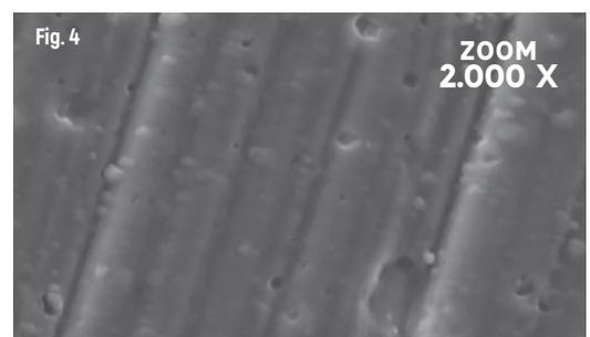
**TRATTATO** - Dalla superficie rivestita dell'utensile sono state rimosse le macro-particelle migliorandone sensibilmente la capacità di scorrimento.
