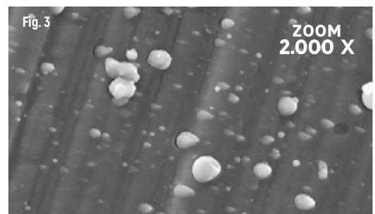
**NON TRATTATO** - Ingrandimento della superficie di un utensile rivestito che evidenzia la presenza di macro-particelle (droplets).
